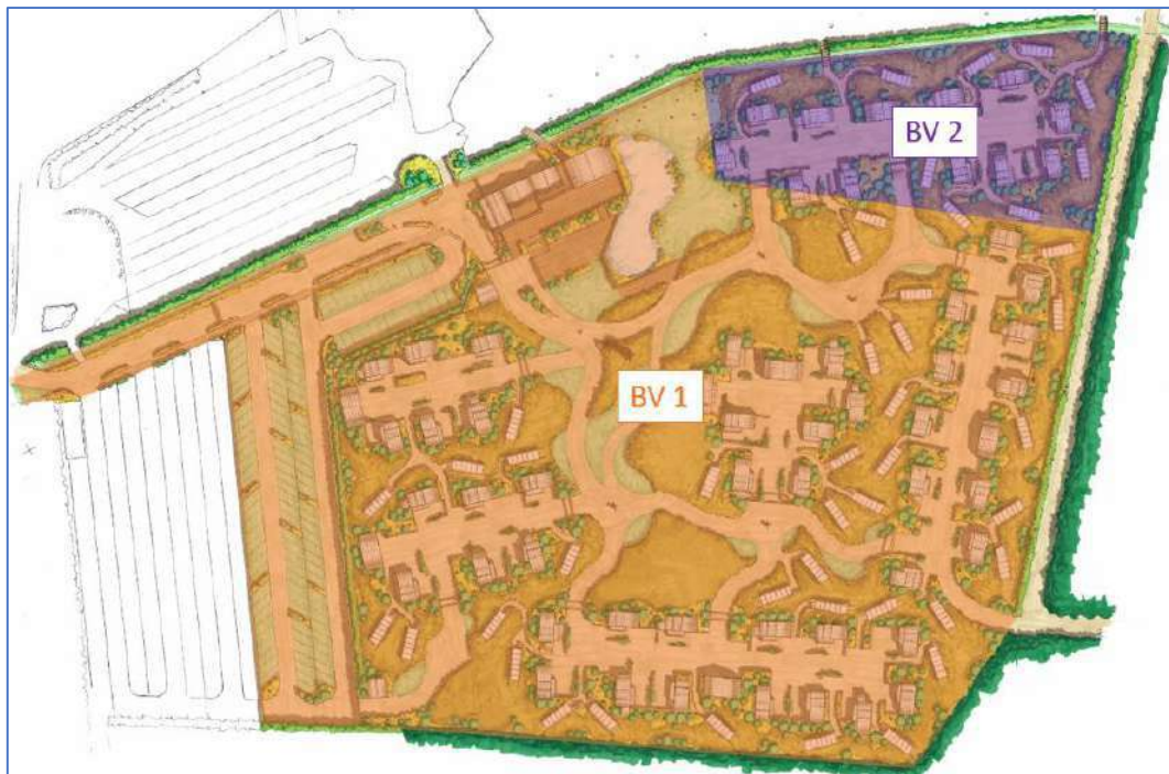
Figure 67 : Plan de découpage des différents bassins versants du projet [AGGRA Concept, ATDG - Avril 2022]
