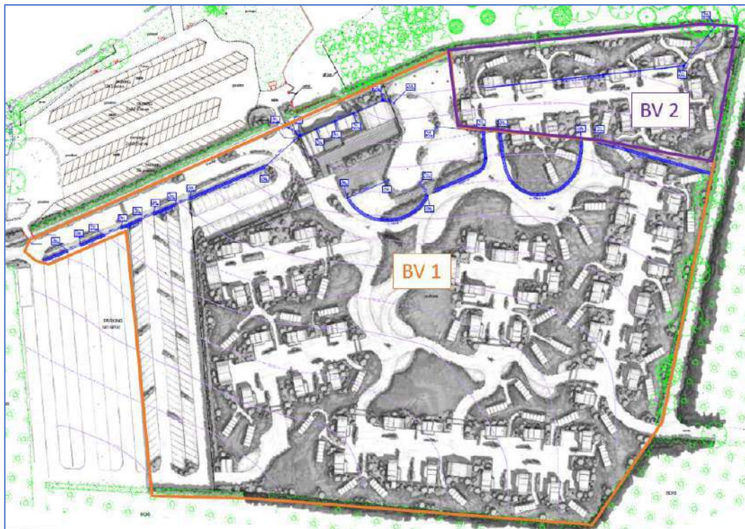
Figure 68 : Proposition de localisation des ouvrages pour l'assainissement des eaux pluviales du projet [AGGRA Concept, ATDG – Avril 2022]
