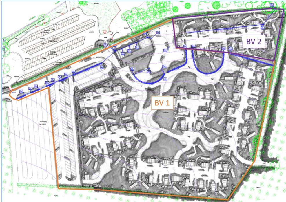
Figure 6 : Proposition de localisation des ouvrages pour l'assainissement des eaux pluviales du projet [AGGRA Concept, ATDG – Avril 2022]
